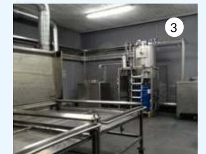
1 : Nettoyage des flexibles 2 : Tiroirs pour bacs à encre et racles, 3. Systèmes de distillation et intégration entre machine à laver des pièces, réservoirs et distillateur
