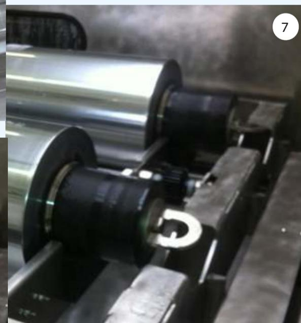
1. L'accumulation d'encre lourde au niveau de la face d'extrémité des arbres de cylindre est une tâche de nettoyage difficile. Avec le nettoyage automatisé de l'unité MCC, les brosses de face d'extrémité rotatives éliminent tous les résidus d'encre pendant le cycle de lavage.
