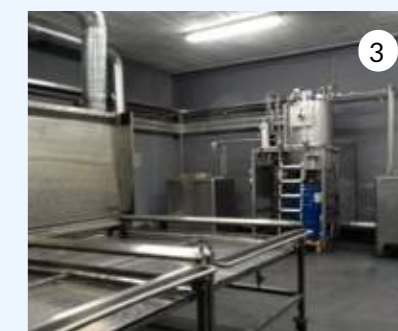
1 : Nettoyage des flexibles 2 : Tiroirs pour bacs à encre et racles, 3. Systèmes de distillation et intégration entre machine à laver des pièces, réservoirs et distillateur.
